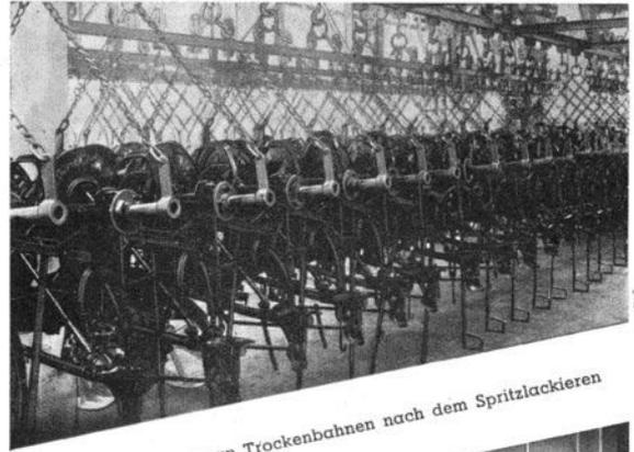
Grasmähergehäuse an Trockenbahnen nach dem Spritzlackieren
