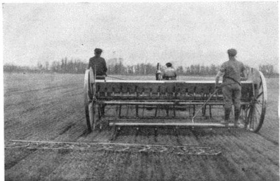
In einem Arbeitsgang Drillen und Eggen mit dem LANZ Bulldog
