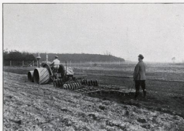
Großbulldog mit Scheibenegge Tages-Leistung: etwa 30-40 Morgen / Schwerölverbrauch: etwa 2 kg pro Morgen Brennstoffkosten: etwa 34 Pfg. pro Morgen
