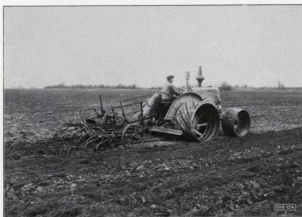
Großbulldog grubbert 2,5 m breit Tages-Leistung: etwa 30-40 Morgen / Schwerölverbrauch: etwa 2 kg pro Morgen Brennstoffkosten: etwa 34 Pfg. pro Morgen
