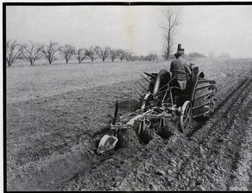
Großbulldog mit Spezialrädern und Greifern beim Einpflügen von Mist auf leichtem Sandboden
