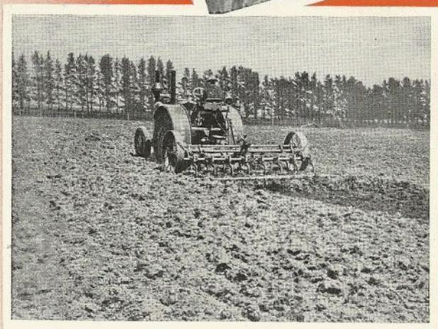
Auf vierfache Art kann die unermüdliche Kraft beim LANZ-Bulldog abgenommen werden. Über Zughacken und Anhängeschiene, Riemenscheibe, Zapfwelle und den hydraulischen Kraftheber, der - soweit gewünscht - die Leistungsfähigkeit des Bulldog auf eine neue Art erweitert.
