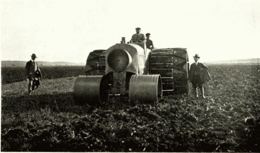
ABBILDUNG 25. LANDBAUMOTOR LANZ BEI DER ARBEIT AUF URBAR GEMACHTEM MOOR
