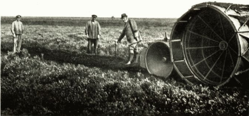
ABBILDUNG 16. ERGEBNIS EINES ARBEITSGANGES MIT DEM LANDBAU-MOTOR LANZ AUF ROHEM HOCHMOOR
