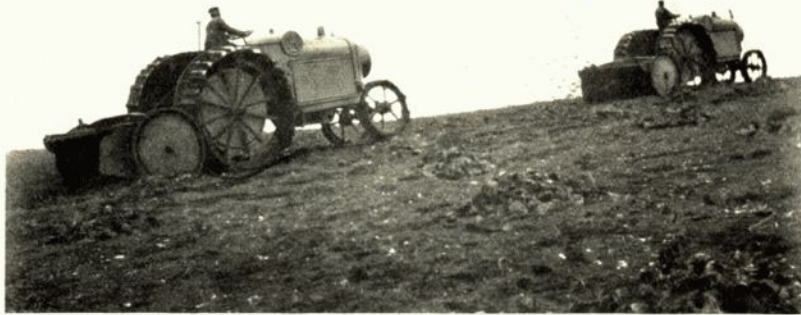
ABBILDUNG 21. ZWEI ARBEITENDE LANZBAU-MOTOREN LANZ MIT RADSCHUHEN AUF DEN HINTERRÄDERN
