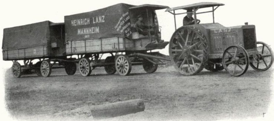
Der Feldmotor Lanz zieht 2 Anhängewagen mit 8000 kg = 160 Zentner Gesamtlast eine Steigung von 5% hinauf.
