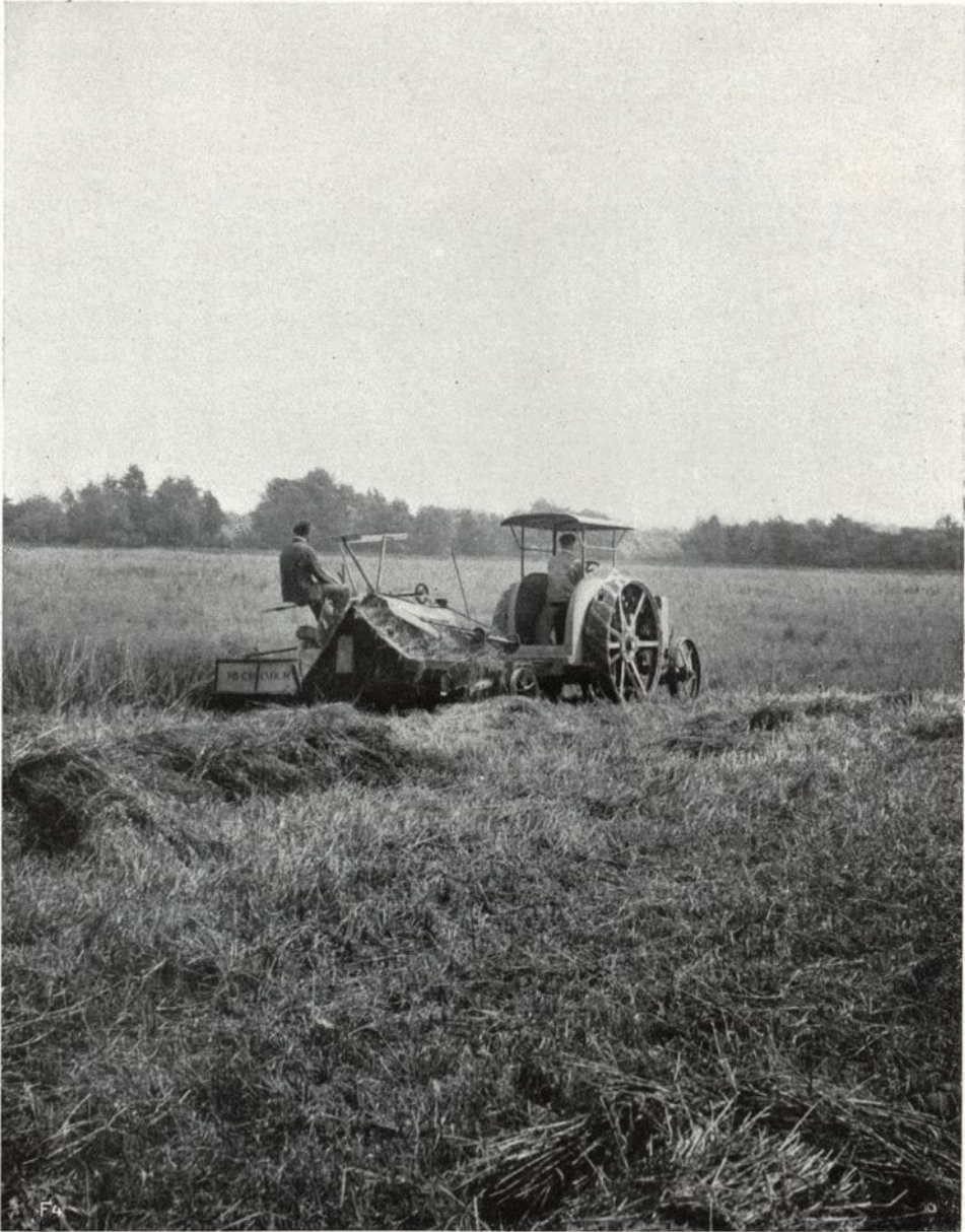
Der Feldmotor Lanz zieht einen Mc Cormick Selbstbinder in schwerem Lagergetreide.
