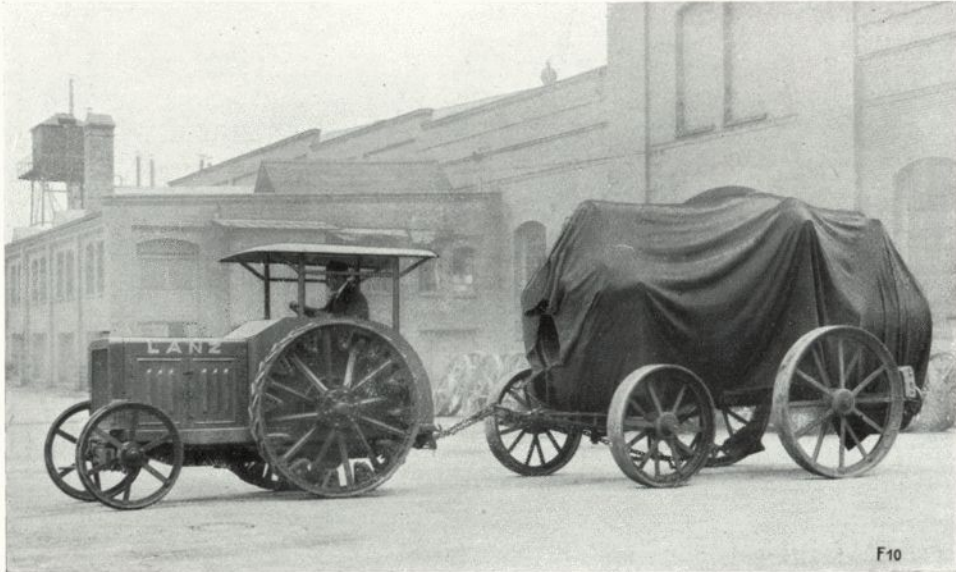
Der Feldmotor Lanz zieht einen Lokomobilkeffel mit 12000 kg = 240 Zentner Gesamtgewicht.
