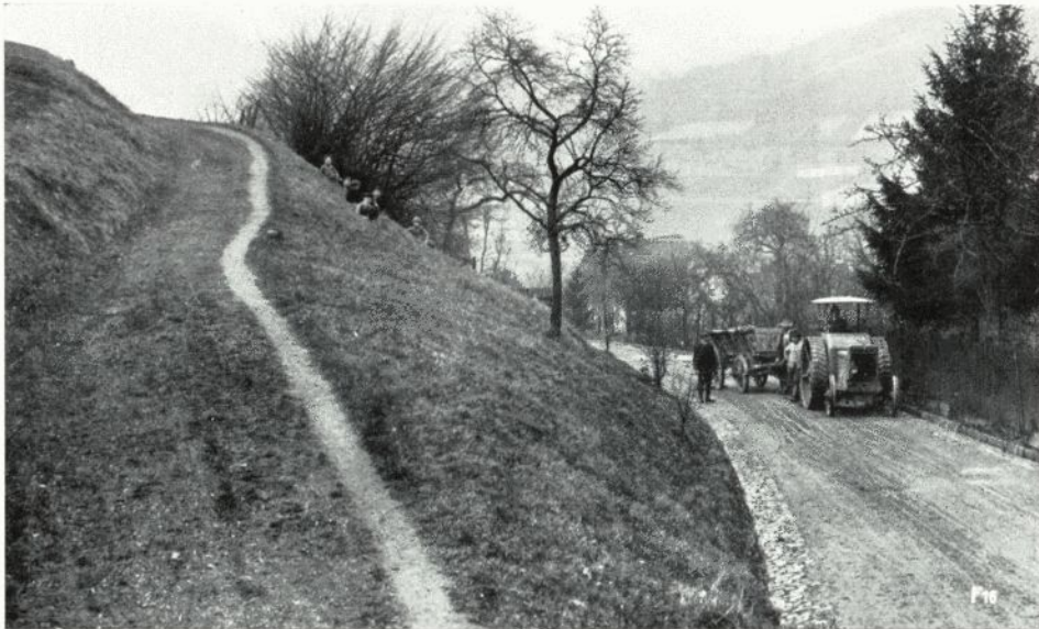
Der Feldmotor Lanz zieht einen Kieswagen von 80 Zentnern Gefamtlast auf eine Anhöhe mit 10 0 / 10 höchster Straßensteigung.
