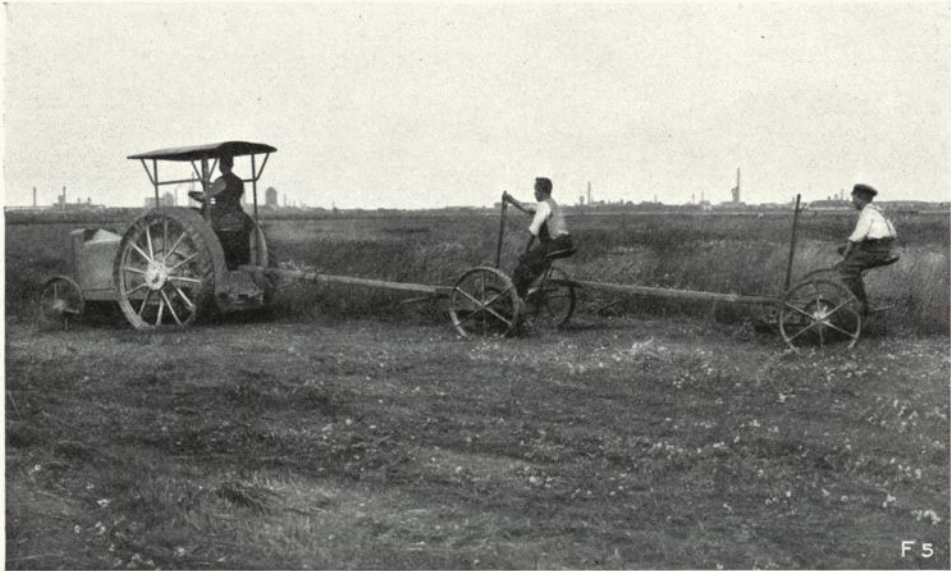
Der Feldmotor Lanz zieht 2 angehängte Grasmäher mit dem II. Gang (3,7 km in der Stunde).
