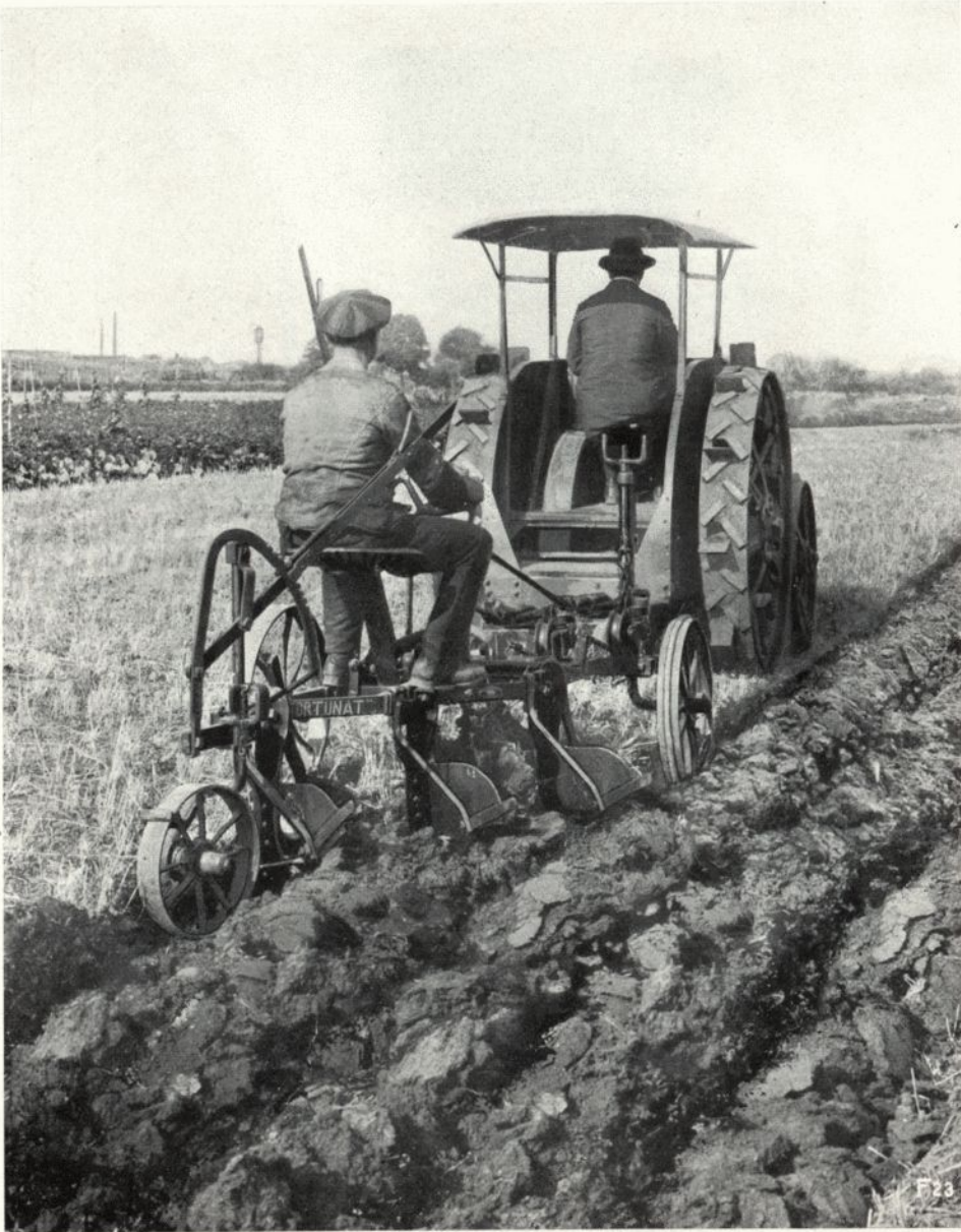
Der Feldmotor Lanz zieht einen Dreifchar-Anhängepflug von Gebr. Eberhardt-Ulm bei herausgestellten Greifern.
