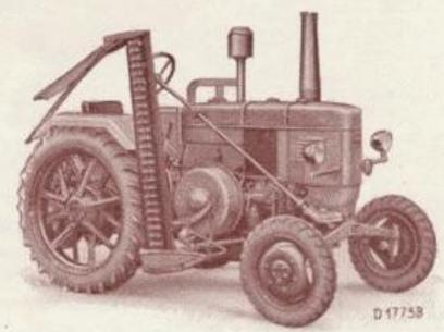
Aushebung mit Hand oder hydraulisch mit Kraftheber.
